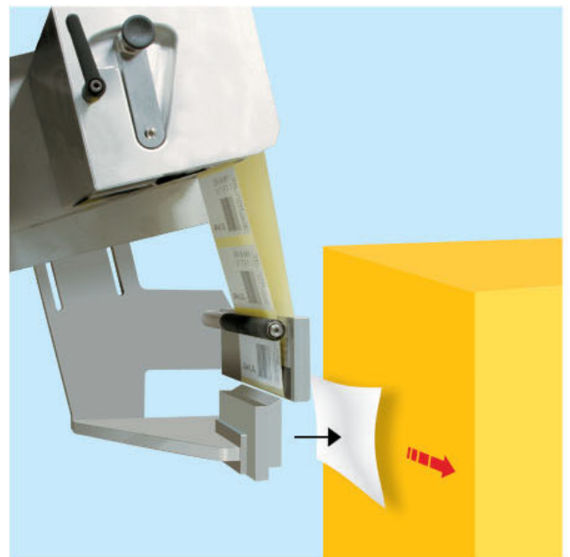
Typ B 90: Serien-Etikettierung Anblasvorrichtung für berührungslose Applikation 90° zur Druckrichtung
